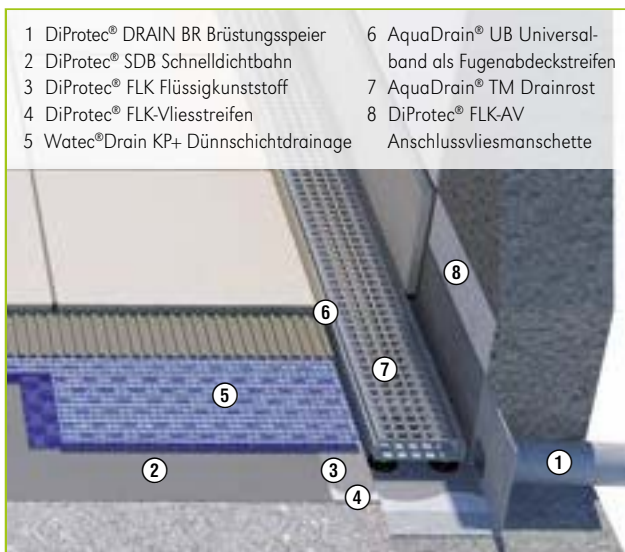
Balkonbrüstung mit Linienentwässerung und Brüstungsspeier
